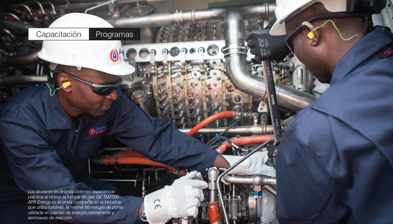
Los técnicos en Angola obtienen experiencia práctica al operar la turbina de gas GE TM2500. APR Energy es la única compañía en la industria que utiliza turbinas, la misma tecnología de punta utilizada en plantas de energía permanente y aeronaves de reacción.
